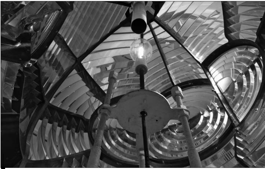
Le système dioptrique : intérieur d'une lentille de Fresnel avec une seule source lumineuse au centre. Photo : Jean Cloutier
