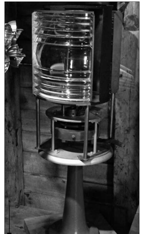
Lentille de 4 e ordre avec mécanisme d'horlogerie sous le plateau de la lentille comme il y avait au phare de l'île de Bellechasse. Photo : Jean Cloutier
